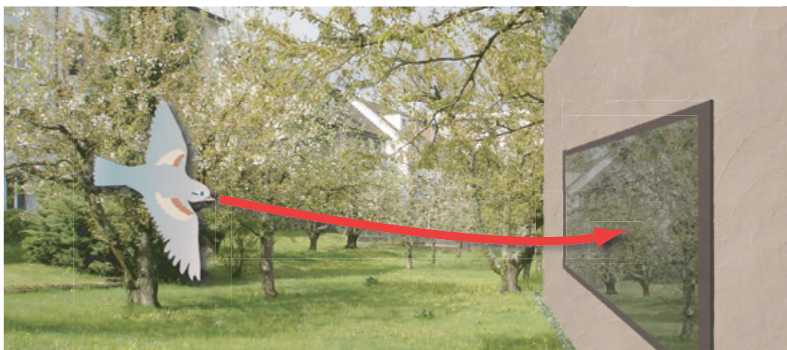
Ochranná sluneční skla a další druhy zasklení mají vysoký index odrazivosti. Čím silnější je odraz a čím atraktivnější je odrážené prostředí, tím vyšší je míra kolizí.
