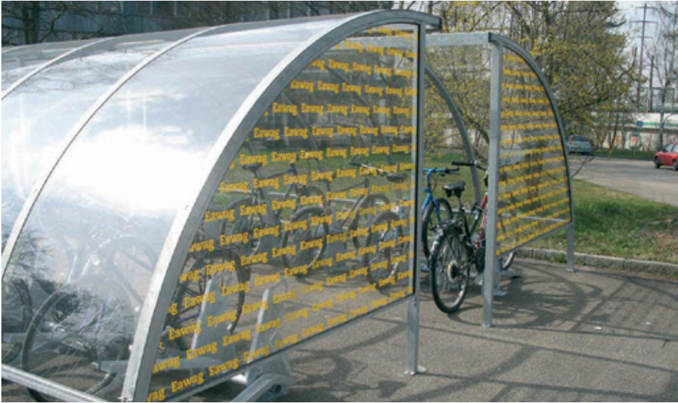
Přístřešek pro kola, na kterém jsou problematické svíslé boční stěny pro ochranu před kolizemi ptáků potištěny logem společnosti
